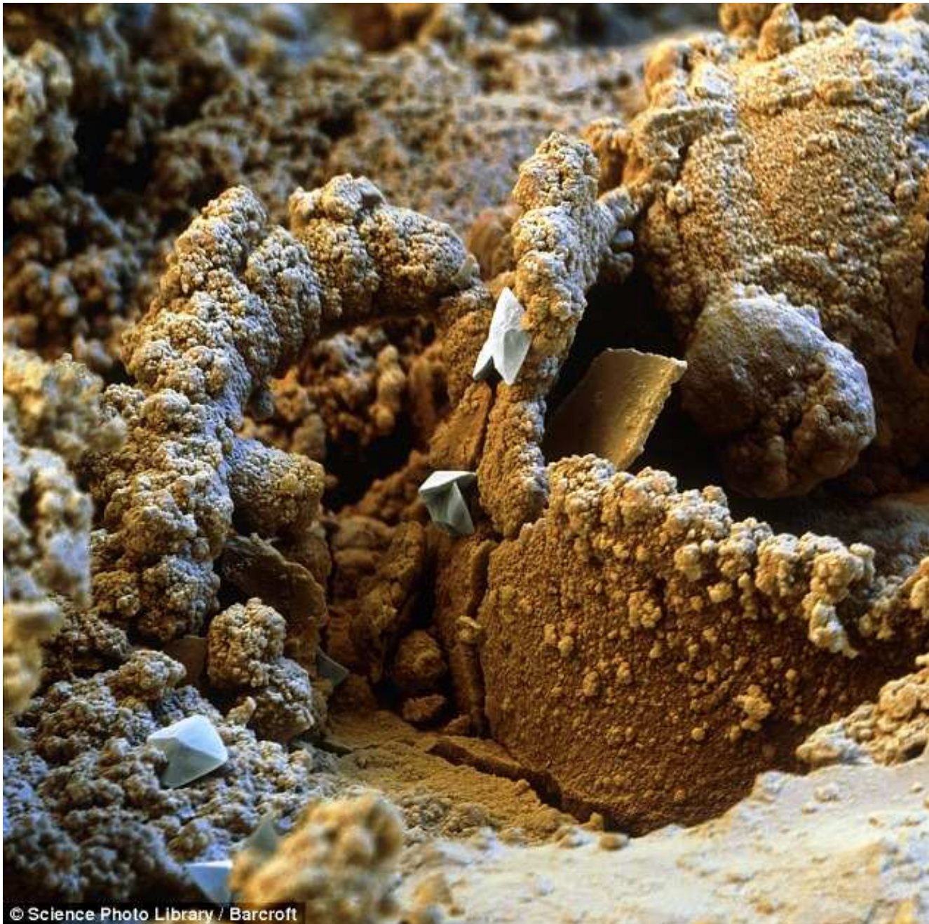
一个生锈的金属钉的表面上像腐蚀环境中，当一个陌生的放大 600 倍
